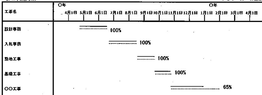
1. 工事予定を点線の棒線で示し、その上に工事進捗状況を実績の棒線で示すこと。
