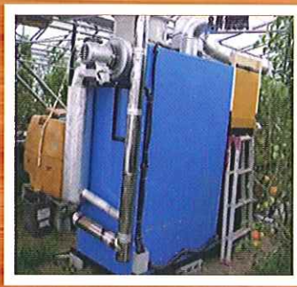
農業用ハウス用 木質ペレット加温機
